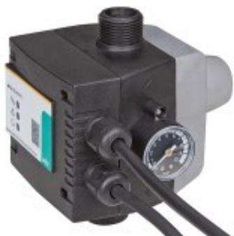
est un dispositif de protection de la pompe en cas de manque d'eau. L'appareil contrôle également le démarrage et l'arrêt de la pompe en fonction des conditions de pression / débit de l'installation. - installation verticale uniquement - manomètre 0 - 10 bar - courant 10 A - classe de protection IP 65 - pression de service max. : 10 bar - pression d'allumage fixe : 1.5 bar - débit max. : 10'000 l/h - connexion DN 25 (1") - température max. du fluide : 60° C HiControl 1-EK
