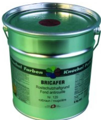
est un fond antirouille aux résines alkydes modifiées, séchant à l'air, ayant une excellente adhérence sur fer et acier. Il sèche rapidement, a un bon remplissage et est très résistant à l'usure mécanique. L'excellent pouvoir antirouille est basé sur le système de phosphates de zinc modifiés et renforcé par des additifs inhibiteurs de rouille.
