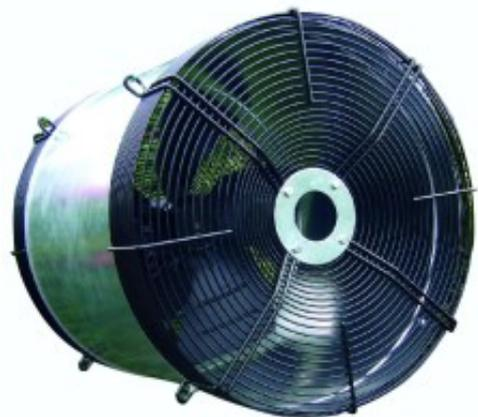
boîtier en acier inoxydable avec 4 attaches fixées au ventilateur, très bonne sortie d'air en largeur, grâce à la géométrie des tôles de guidage d'air. Données techniques : - tension : 230 V - fréquence : 50 Hz - brassage : jusqu'à 5'000 m<sup>3</sup>/h - nombre de tour : 900 t/min. - puissance absorbée max. :190 W - consommation de courant : 0.86 A - température : -40° C à +65° C - réglage par palier
