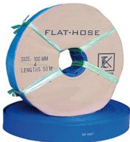
selon le niveau de pression requis, l'Irritec Flat Hose™ est idéal pour les conduites d'alimentation temporaires et saisonnières, ainsi que pour les conduites de distribution qui doivent être posées fréquemment. Le tuyau plat en tissu Flat Hose™ est polyvalent, inodor et fiable, et peut donc être utilisé dans toutes les cultures. - ø 2" - ø intérieur 52 mm - épaisseur de paroi 1.35 mm - 0.27 kg/m - max. 4.5 bar rouleau de 100 m
