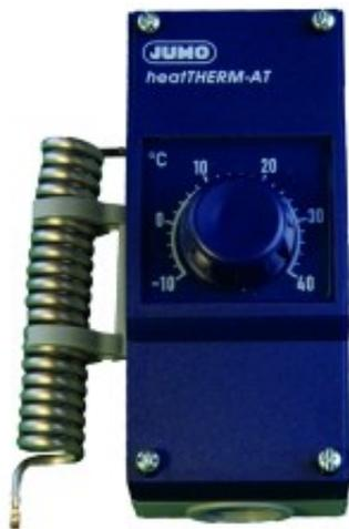
régulateur de température ambiante, monté dans boîtier, avec sonde en spirale en acier spécial CrNi, réglage de la température de l'extérieur au moyen d'un bouton. Exécution : boîtier plastique résistant aux chocs, indice de protection IP 54.
