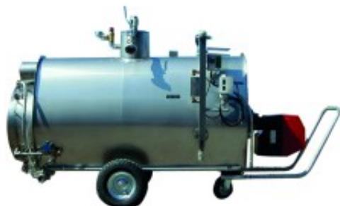
En acier inox-nicklé, appareil avec régulateur de niveau d'eau électronique, régulateur de pression automatique par pressostat et une vanne de sécurité de poids indépendante, le tout monté sur l'appareil avec les raccords nécessaires. Equipé d'un blûleur Elco ou Oertli.
