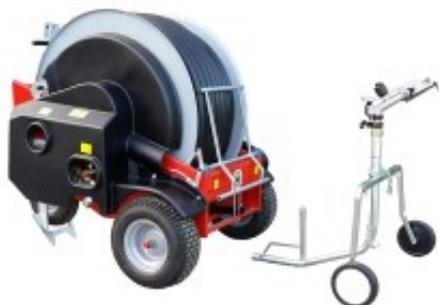
120 m de tuyau PE 1 1/4", entraînement par turbine 10 - 30 m/h, intensité d'irrigation réglable, distance de projection jusqu'à 19 m (à 5.5 bar), débit d'environ 3.4 - 7.4 m<sup>3</sup>/h, chariot d'arrosage avec arroseur à secteur, soupape de surpression, arrêt automatique, guidage automatique du tuyau pour l'enroulement, 246 kg
