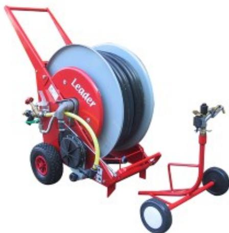
50 m de tuyau PE 3/4", entraînement par turbine 10 - 40 m/h, intensité d'irrigation réglable, distance de projection jusqu'à 12 m (à 4 bar), débit d'environ 1 - 2.5 m<sup>3</sup>/h, chariot d'arrosage avec arroseur à secteur, soupape de surpression, arrêt automatique, 75 kg
