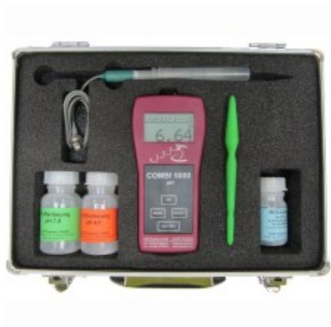
pour la mesure de l'acidité du sol ainsi que de l'eau. Données techniques : - capacité de mesure : 0 - 14 pH - résolution : 0.01 pH - précision :  $\pm 0.02$  - alimentation batterie : 1 x 9 V - pour env. 4'000 mesures avec malette
