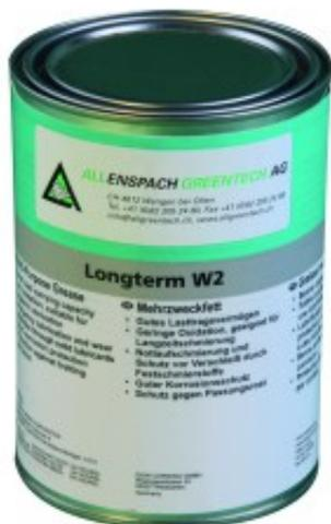
Graisse spéciale pour les supports en aluminium, bonne capacité de charge ; pas de tendance à l'oxydation, donc adapté à la lubrification à long terme ; protection contre l'usure par des lubrifiants solides ; bonne adhérence grâce aux produits d'adhérence incorporés Température de fonctionnement: -30°C à +110°C Bidon de 1 kg
