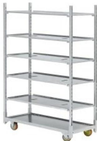
est le chariot le plus utilisé dans la logistique des horticulteurs et de la floriculture. C'est l'outil idéal pour le transport de fleurs et de plantes. Dimensions standard pour la floriculture. Se compose d'un plancher, de quatre poteaux, de 2 roulettes fixes et 2 roulettes pivotantes ø 125 mm galvanisées à chaud. longueur : 1'350 mm | largeur : 565 mm | hauteur : 1'900 mm
