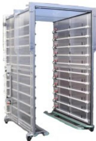
Pour l'irrigation des plantes sur des conteneurs CC. Le système peut être utilisé avec une pompe de min. 6 m<sup>3</sup> de puissance par heure. 11 lignes d'irrigation par côté, réglables individuellement. Construction en aluminium plaqué avec des plaques plastique doubles. Buses d'irrigation 100 l/h. Châssis avec 2 roulettes, verrouillable. Données techniques : - hauteur ext. : 2.66 m - hauteur int. : 2.60 m - longueur : 1.70 m - largeur ext. : 1.48 m - largeur int. : 0.60 / 1.10 m
