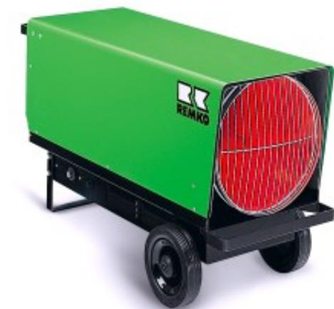
le chauffage de poste rapide pour l'intérieur et l'extérieur. Les automates de chauffages REMKO des séries PGM et PGT ont été conçus pour un emploi universel fiable et sans problème. Eprouvé dans l'agriculture et l'horticulture. - raccordement électrique : 230 V - puissance calorifique nominale : 50/100 kW - débit d'air : 3'260 m<sup>3</sup>/h - dimensions : L 1'060 x l 435 x H 620 mm - poids : 47 kg
