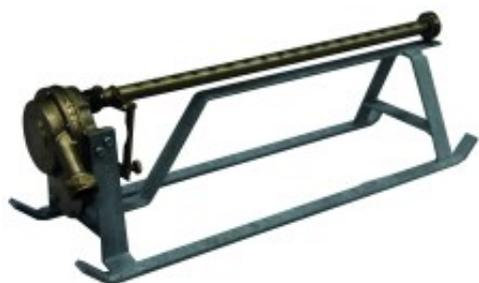
pour arrosage carré d'env. 13 x 16 m (env. 210 m<sup>2</sup>). L'appareil est raccordé à un tuyau de 19 mm ou 25 mm de  $\varnothing$  intérieur et fonctionne déjà à une pression de 1 1/2 à 2 bar. La surface arrosée peut être réduite au moyen d'une vis. Fabrication Suisse en bronze, laiton et acier galvanisé à chaud. raccord : F 3/4" | poids : 4.5 kg | longueur : 60 cm | largeur : 20 cm | hauteur : 20 cm
