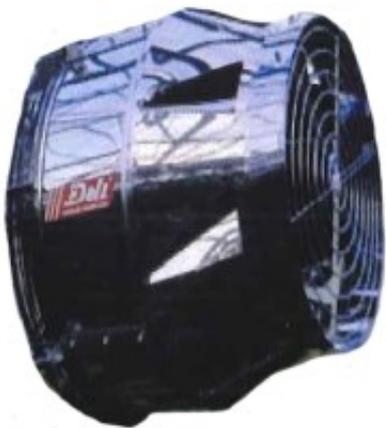
Technische Daten: - Nennspannung: 230 V - Frequenz: 50 Hz - Volumenstrom: 0 bis 5'000 m<sup>3</sup>/Std. - Drehzahl: 900 U/Min. - Leistungsaufnahme: max. 190 W - Stromaufnahme: 0.86 A - Temperatur: -40° C bis +65° C - Stufenschaltbar
