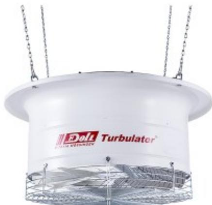
für Gewächshäuser, Gehäuse aus Spezialedelstahl mit 4 Aufhängeösen am Gerät, hohe Energieeinsparung im Winter durch Wärmerückführung in den Pflanzen- bzw. Messbereich der Raumthermostate. Technische Daten: - Nennspannung: 230 V - Frequenz: 50 Hz - Volumenstrom: 5'000 m<sup>3</sup>/Std. - Drehzahl: 940 U/Min. - Leistungsaufnahme: max. 165 W - Stromaufnahme: 0.8 A - Temperatur: -25° C bis +40° C - Stufenlos Grösse: - ø 83 cm - H 39 cm - Arbeitsfeld ø 24 m
