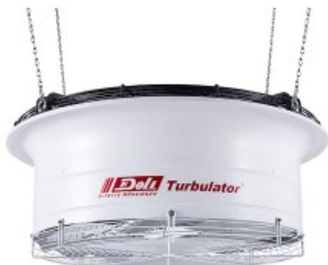
für Gewächshäuser, Gehäuse aus Spezialedelstahl mit 4 Aufhängeösen am Gerät, hohe Energieeinsparung im Winter durch Wärmerückführung in den Pflanzen- bzw. Messbereich der Raumthermostate. Technische Daten: - Nennspannung: 230 V - Frequenz: 50 Hz - Volumenstrom: 5'000 m<sup>3</sup>/Std. - Drehzahl: 940 U/Min. - Leistungsaufnahme: max. 165 W - Stromaufnahme: 0.8 A - Temperatur: -25° C bis +40° C - Stufenlos Grösse: - ø 90 cm - H 40 cm - Arbeitsfeld ø 32 m
