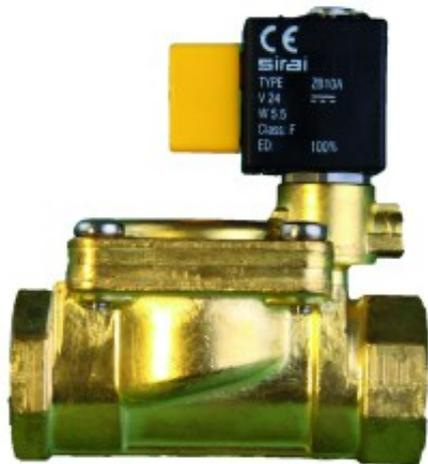
aus Messing, mit Handöffnung, beiseitig mit Innengewinde, geringe Schläge bei Schaltvorgang. Stromlos geschlossen. 24 V AC
