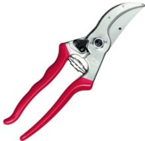
Zuverlässigkeit: komfortable, leichte und robuste Griffe, aus geschmiedetem Aluminium mit lebenslanger Garantie / Klinge und vernietete Gegenklinge aus hochwertigem gehärtetem Stahl / sauberer, präziser Schnitt / alle Teile austauschbar. Wie Modell Nr. 2, jedoch ohne Gummipuffer, Saftrille und ohne Feineinstellung. Länge: 21 cm | Schnitt ø: 25 mm | Gewicht: 220 g
