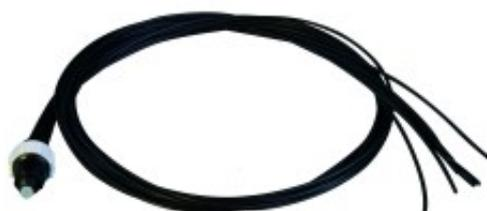
bei einem Druck von ca. 0.6 bis 0.8 bar ergibt sich pro Tropfstelle eine Wasserabgabe von 1.2 l/Std. Der Steva-Düsenverteiler besteht aus: - Verteilkappe - eingesetzten Tropfschläuchen - Düsenunterteil mit 3/8" WW-Gewinde - eingesetztem Reduziernippel zur gleichmässigen Wasserverteilung - TS-Halter
