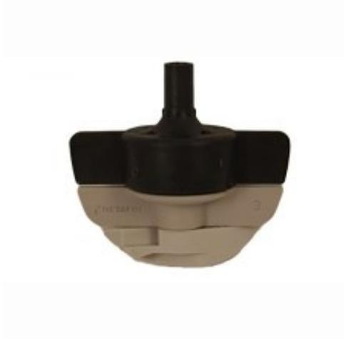
Bügelloser Microsprüher Typ SpinNet, besonders geeignet für den Einsatz im Gewächshaus oder Folientunnel, Anschlussverbinder Pressfit-System Varterteil Ausflussrate 70 l/Std. | schwarze Düse
