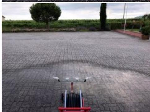
Gestänge mit 3 Düsen 120°, Abdeckfläche 6 - 8 m (bei 70 - 80 l/min. Wasserdurchfluss) Für Leader 25
