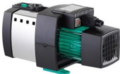
Mehrstufige Kreiselpumpe - geräuscharm und energieeffizient - Wasserversorgung (Trinkwasserzulassungen nach ACS und KTW) - Beregnung, Bewässerung und Berieselung - Regenwassernutzung - Sauganschluss: DN 25 (1") - Druckanschluss: DN 25 (1") - Spannung: 230 V, 50 Hz - Medientemperatur max.: 40° C - Ansaughöhe: 8.5 m - Betriebsdruck: 8 bar
