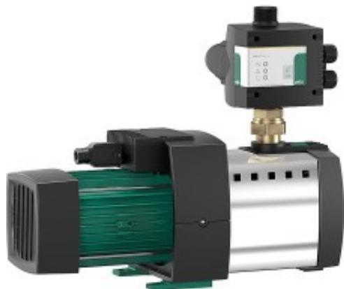
Mehrstufige Kreislumppe mit elektronischem Druckschalter und Trockenlaufschutz - geräuscharm und energieeffizient - Wasserversorgung (Trinkwasserzulassungen nach ACS und KTW) - Beregnung, Bewässerung und Berieselung - Regenwassernutzung - Sauganschluss: DN 25 (1") - Druckanschluss: DN 25 (1") - Spannung: 230 V, 50 Hz - Medientemperatur max.: 40° C - Ansaughöhe: 8.5 m - Betriebsdruck: 8 bar
