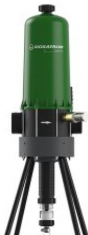
gewährleistet eine genaue Dosierung, bei Veränderung der Förderleistung und des Druckes, passt sich die Einspritzvorrichtung an. Betriebsförderleistung von 1 - 20 m<sup>3</sup>/Std., 0.12 - 10 bar, Dosierskala 0.2 - 2 %, 2" Anschluss. Weitere Vorteile: - kein Stromnetz nötig - breite Dosierskala - Aussenregulierung - getrenntes Einspritzsystem - integriertes Rührwerk - eingebautes Umlaufsystem - kompakt und tragbar
