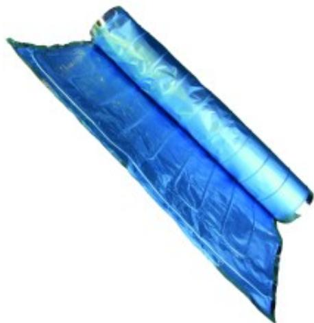
Heizmatte mit Silikon isolierten Heizdrähten, die zwischen zwei Aluminiumschichten eingelassen sind - mit Anschlusskabel - kann über Thermostat gesteuert werden - mit Schuko Stecker - Leistung pro m<sup>2</sup> : 150 W (230 V) Weitere Grössen auf Anfrage (Länge: 2 bis 10 m, Breite: 0.50 bis 1.80 m)
