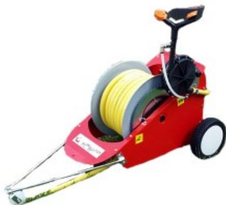
30 m PVC-Schlauch 3/4", Turbinenantrieb 10 - 20 m/ Std., Regnerwagen mit 360° Sektorregner, Wurfweite bis 10 m (bei 4 bar), Wasserverbrauch 10 - 15 l/min, Durchfluß ca. 0.6 - 0.9 m<sup>3</sup>/ Std., Führungsrolle für 3/4" Schlauch. Wird über den vorgelegten Schlauch eingerollt. Dadurch lassen sich auch Kurven und ungleichmässige Flächen bewässern. 35 kg
