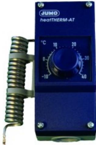
Raumtemperaturregler im Aufbaugehäuse, mit einem Wendefühler aus CrNi (Edelstahl), Temperatureinstellung von aussen mittels Drehknopf. Ausführung: schlagfestes Kunststoffgehäuse, Schutzart IP 54.
