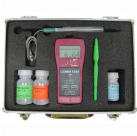
für die Messung des Säuregehaltes im Erdboden sowie im Wasser. Technische Daten: - Messbereich: 0 - 14 pH - Auflösung: 0.01 pH - Genauigkeit:  $\pm 0.02$  - Stromversorgung: 1 x 9 V Batterie - für ca. 4'000 Messungen mit Koffer
