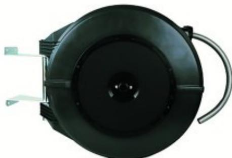
UV-stabilisiertes, schlagfestes Gehäuse aus Polypropylen, mit Schlaucharretierung, Wandhalter 180° schwenkbar aus verzinktem Stahl, inkl. 20 m SMT-Schlauch 5/8" mit Messingarmaturen, Gewicht 12kg
