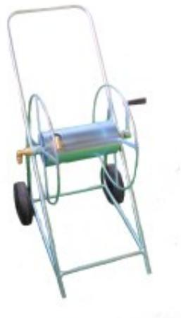
Aus promatverzinktem Stahl. Wassereingang 3/4" Zylinder 250 mm, mit Anschluss aus Messing für 80 m von 13 mm Schlauch oder 50 m von 15 mm Schlauch.
