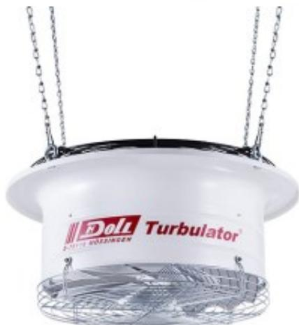
für Gewächshäuser, Gehäuse aus Spezialedelstahl mit 4 Aufhängeösen am Gerät, hohe Energieeinsparung im Winter durch Wärmerückführung in den Pflanzen- bzw. Messbereich der Raumthermostate. Technische Daten: - Nennspannung: 230 V - Frequenz: 50 Hz - Volumenstrom: 5'000 m<sup>3</sup>/Std. - Drehzahl: 940 U/Min. - Leistungsaufnahme: max. 165 W - Stromaufnahme: 0.8 A - Temperatur: -25° C bis +40° C - Stufenlos Grösse: - ø 60 cm - H 27 cm - Arbeitsfeld ø 16 m
