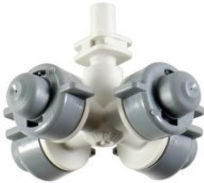
NETAFIM Sprühnebeldüse Typ CoolNet, bei niedrigem Betriebsdruck von 4 bar sehr gleichmässige Verteilung der Tröpfchen (ca. 90 Mikrometer), damit ist eine Lufttemperatursenkung durch Verdunstung der Tröpfchen möglich. Düsenkreuz mit 4 Düsen. Anschlussverbinder Preffit-System Vateil. Ausflussrate: 7.5 l/Std. je Düse (30 l/ Std. total)
