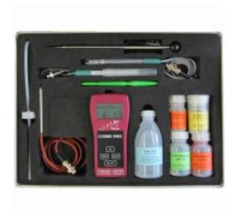
für die Sofortmessung der wichtigsten Parameter in der Pflanzenproduktion: - pH-Messung - EC-Messung - Salzgehalt Bodenfeuchte - Temperatur mit Koffer
